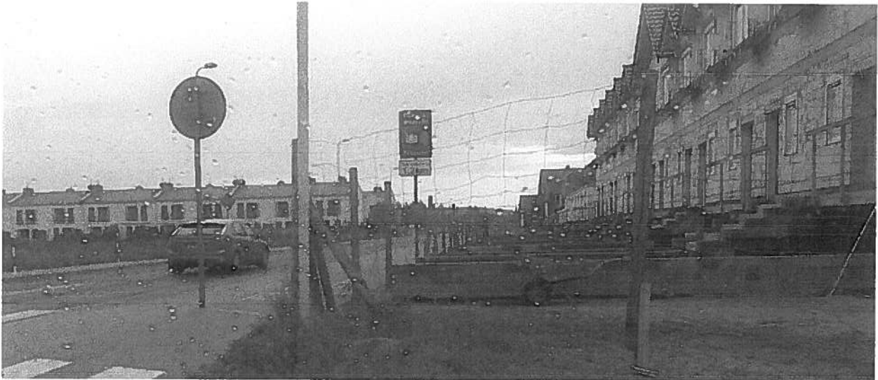
Ul. Strzelecka. Wyjazd z garaży jest bezpośrednio na ścieżkę rowerową. Widoczność ograniczają murki o wysokości ok. 40 cm.
